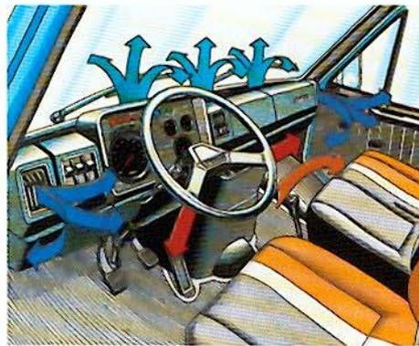
L'installation de ventilation comprend sept diffuseurs orientables pour la distribution de l'air frais.
