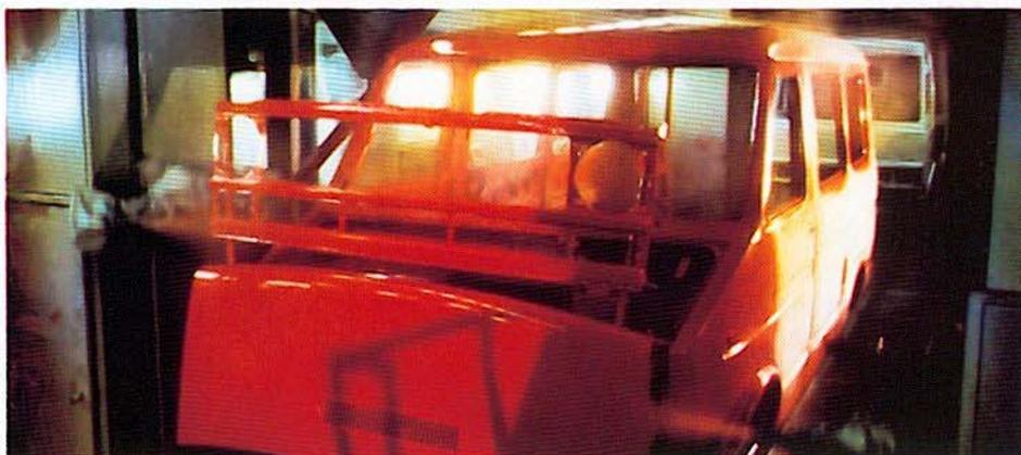
résister à des températures de  $-30^{\circ}$ ; les parties des charnières en contact sont protégées par des tôles de zincfix. Les corps creux sont recouverts de produits cireux. Le cadre de châssis est intégralement traité, même sur les surfaces les plus difficiles à atteindre.
